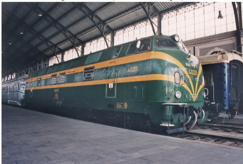
Locomotora diésel de línea de gran potencia 4020, con transmisión hidromecánica Mekydro, construida por Kauss Maffei y Babcock and Wilcox, entre 1966 y 1969. Museo del Ferrocarril de Madrid. FFE.
