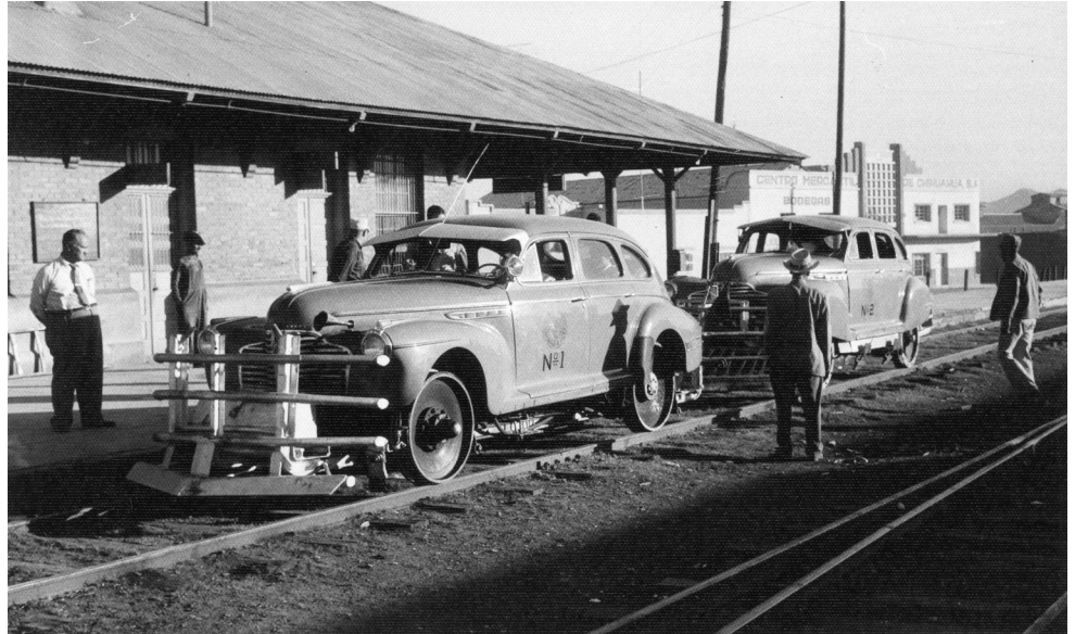
Dos coches adaptados para vía frente a la estación de Chihuahua, 1957. Colección: donaciones al Cedif. Secretaría de Cultura, CNPPCF, Cedif.
